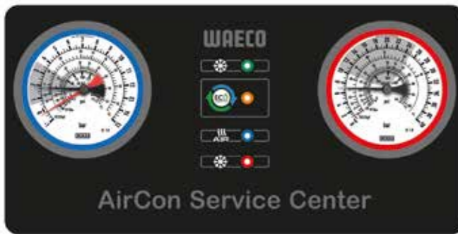
Niederdruck normal (I) oder zu niedrig (s)
